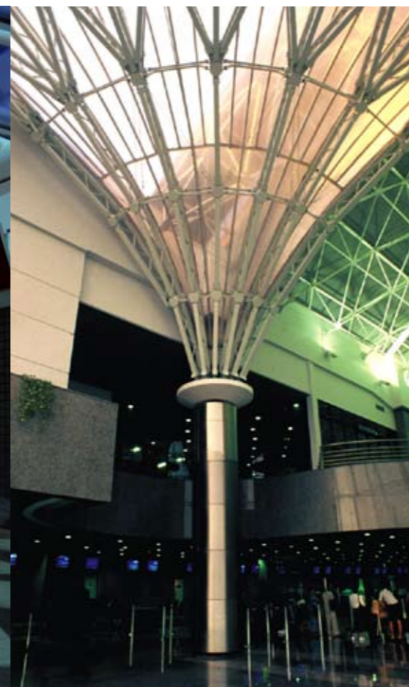
No aeroporto de Fortaleza (acima e abaixo), uma malha curva cobre o vão central. As obras da construção de quatro andares foram realizadas em dois anos, sem impactar o edifício vizinho, um prédio dos anos 1960
